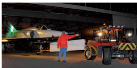
Terratrak als Schlepper
