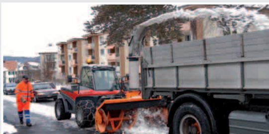
Terratrak mit Schneefräse/Verladekamin
